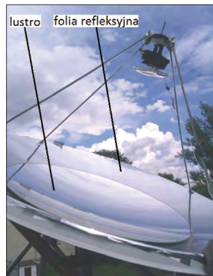
Rys.2. Widok koncentratora promieniowania wraz z umieszczonym ogniwem PV
